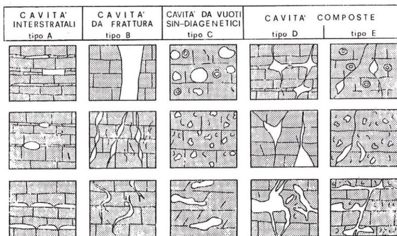
Fig. b – Principali tipologie delle cavità carsiche presenti nel sottosuolo (da F. Zezza 1977).
