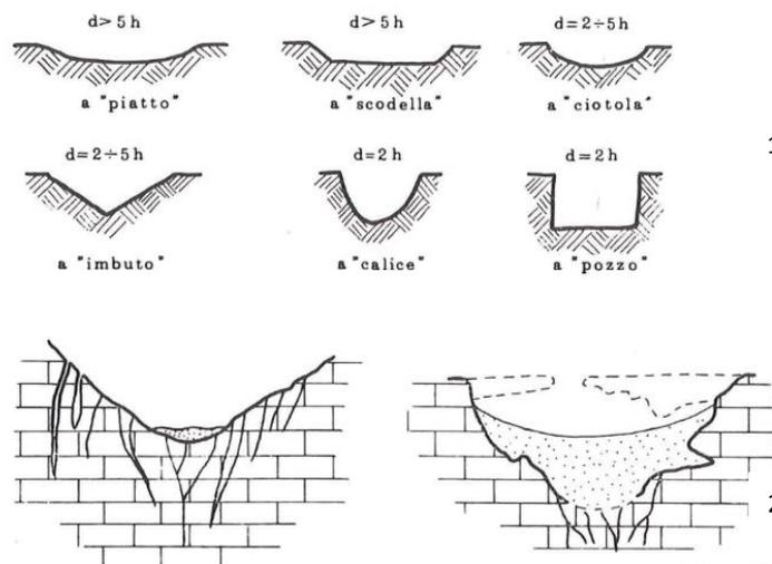
Fig. a – Esempi di doline regolari distinguibili in sei tipi sulla base della forma e delle dimensioni (1) e principali processi genetici (2), da F. Zezza 1977.
