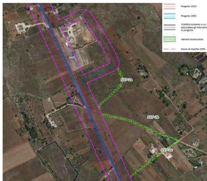
**Figura 10 Svincolo 7-2 Scorrano Sud con indicazione delle varianti localizzative SV7-2a, SV7-2b e SV7-2c.**
