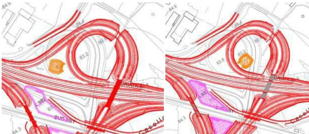
**Figura 1 Svincolo 1 Maglie Nord - A sinistra l’attuale localizzazione della vasca di smaltimento delle acque di piattaforma e a destra la precedente posizione.**
