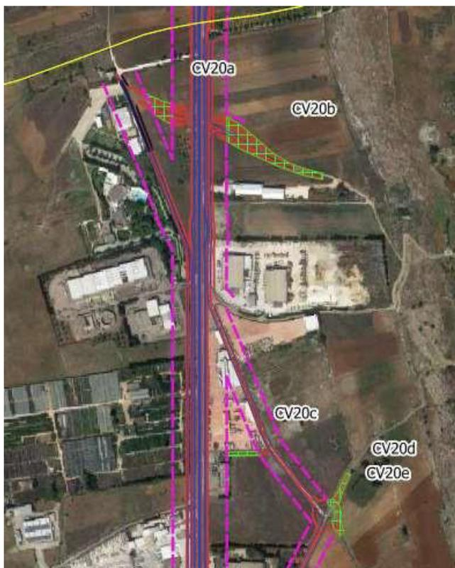
**Figura 16 Scavalco 2 e complanare CV20 con indicazione delle varianti localizzative CV20a, CV20b, CV20c, CV20d e CV20e**
