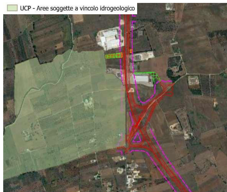
Figura 19: Interferenza con il vincolo idrogeologico in prossimità della variante d’ambito SV11
