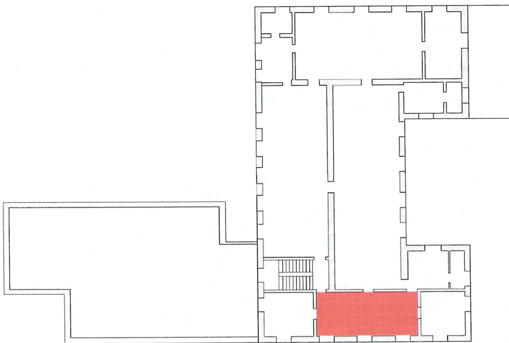
Pianta Piano Primo (in rosso la parte di solaio crollato)
