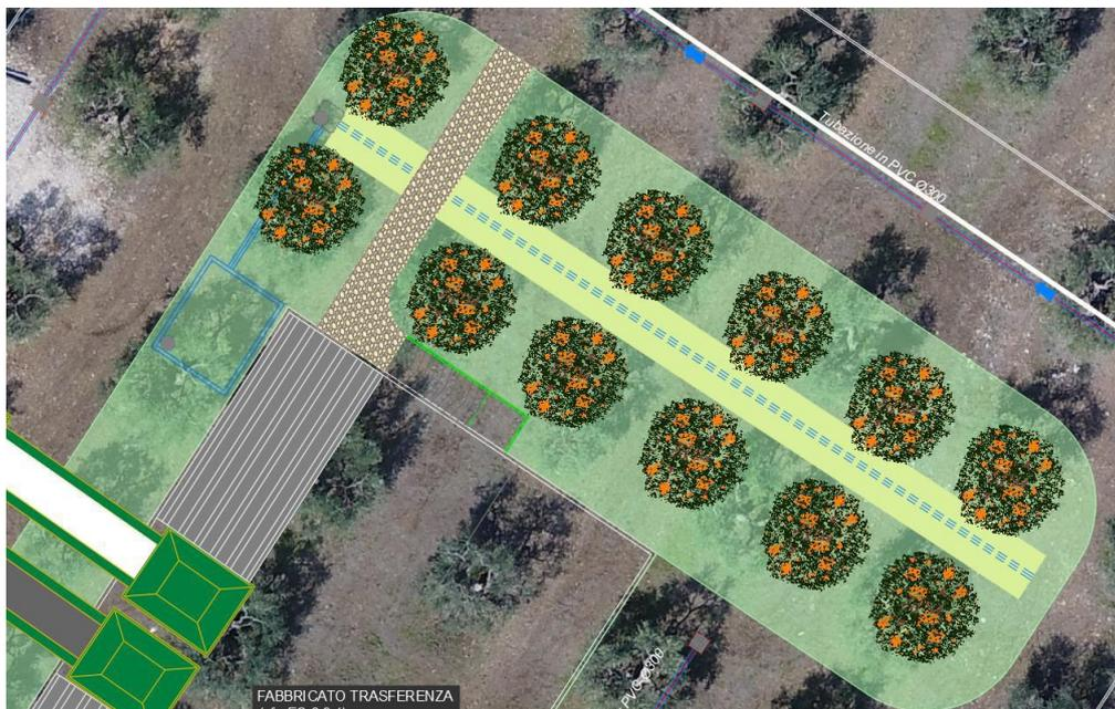
Figura 4.9: Vasca di accumulo (in blu) e trincea disperdente (in giallo) per smaltimento acque dilavanti la copertura del capannone
