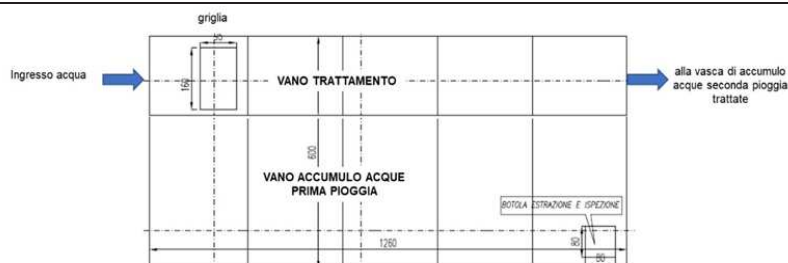
Figura 2: Impianto trattamento acque meteoriche. Vista in pianta
