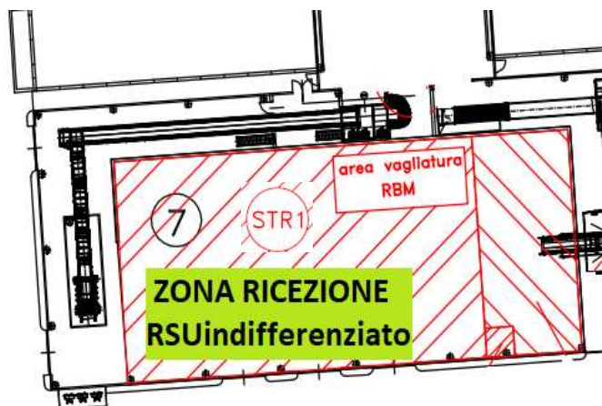
Figura 13: Zona ricezione per il deposito dei rifiuti in ingresso prima del trattamento (STR1)
