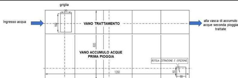
Figura 2: Impianto trattamento acque meteoriche. Vista in pianta
