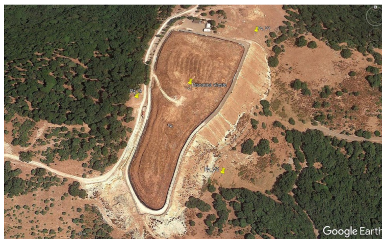
Figura 7: Proposta di ubicazione piezometri di monitoraggio falda
