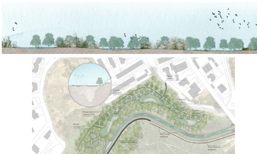
Particolare: creazione di aree umide fuori alveo presso il canale Brunese (da tav. 7)
