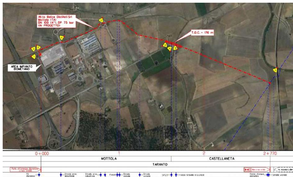
Occorre subito evidenziare che l'attraversamento del cosiddetto "fosso" alla progressiva 0+982 del metanodotto, ricade in agro di Mottola e riguarda l'intersezione con un'opera di raccolta e convogliamento delle acque meteoriche della zona industriale. Detta canalizzazione a cielo aperto che corre al piede delle scarpate stradali e della linea ferroviaria (Bari – Taranto) dismessa, ricade nella proprietà e quindi nella competenza del Comune di Mottola.
