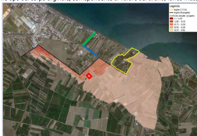
Variazione, su ortofoto, dei tiranti idrici nella configurazione dello stato attuale e dello stato di progetto, in prossimità dell'argine di progetto (in nero), impianto di depurazione (in rosso), canale Cannafesca (in azzurro), zona umida Lagacchione (in verde).
