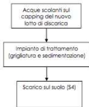
Figura 12 – Schema di trattamento di progetto acque meteoriche afferente ad S4
