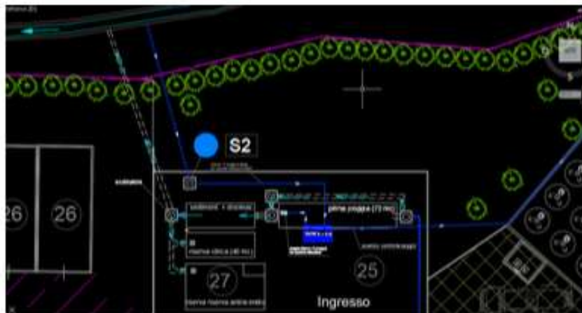
Figura 10 – Particolare impianto di trattamento acque meteoriche afferente allo scarico S2
