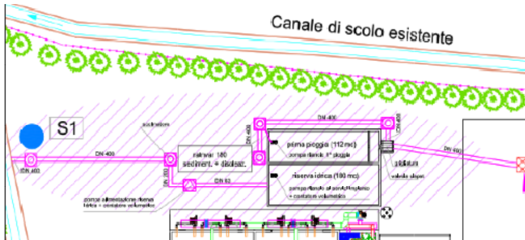
Figura 6 - Schema di impianto trattamento acque meteoriche sito esistente (come autorizzato con D.D. n. 247/2019) e punto di scarico S1
