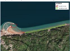
Le operazioni di dragaggio nell'area di accesso al porto prevedono il raggiungimento di una quota batimetrica rispetto al fondale attuale di ca. 4,5 m per un volume di 52.677,98 mc, mentre le aree ad est del molo di sottoflutto prevendono un approfondimento dalla quota di calpestio pari a ca. 1.9 m per un volume di 189.753,21 mc ; quantitativo totale di materiale escavato pari a ca.242.000 mc.
