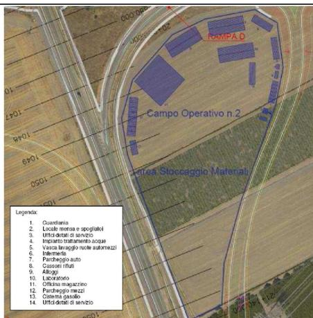
L'Area Tecnica AT\_1, sarà ubicata in prossimità del Cantiere Base CB\_1 "Svincolo 2 tra le progr. km 11+340: 11+ 660 per una superficie pari a circa 26.900 mq.
