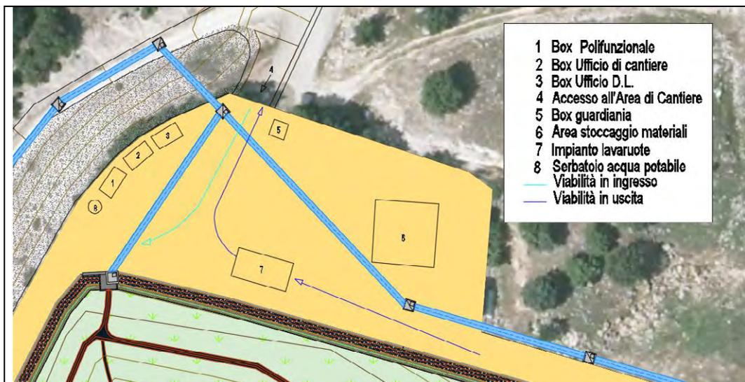
Figura 8: planimetria con area di cantiere
