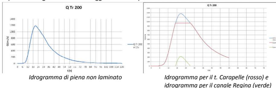
Per il modello del **canale Regina**, simulato in condizioni di moto vario, è stata applicata come condizione di monte l'idrogramma di progetto calcolato per la laminazione del volume di piena del torrente Carapelle.
