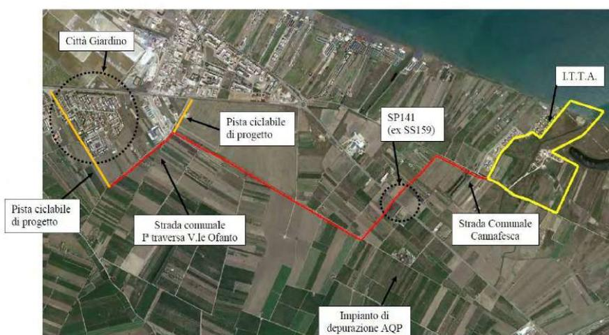
**Figura 1** - Individuazione, su ortofoto, dell'argine di progetto (in rosso), delle piste ciclabili di progetto (in arancione) e dell'argine esistente della zona intitolata "I.T.T.A." (in giallo).
