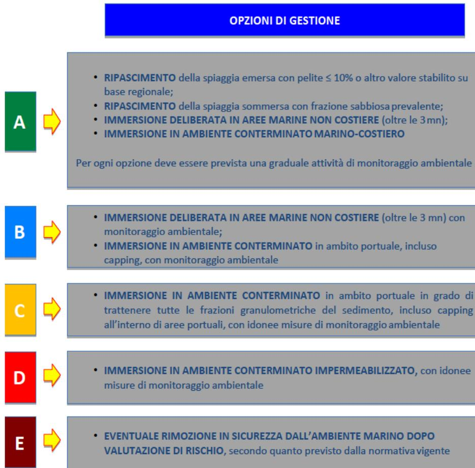
Figura 5. Opzioni di gestione compatibili con la classificazione di qualità dei materiali da dragare (Figura 7 Allegato Tecnico D.M. 173/2016)
