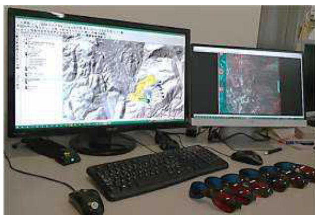
Figura 2-4. Esempio della procedura di riporto a vista: sullo schermo di sinistra si interpreta l'immagine in modalità anaglifo; sullo schermo di destra si riporta in tempo reale l'informazione foto-interpretata in ambiente GIS 2D.
