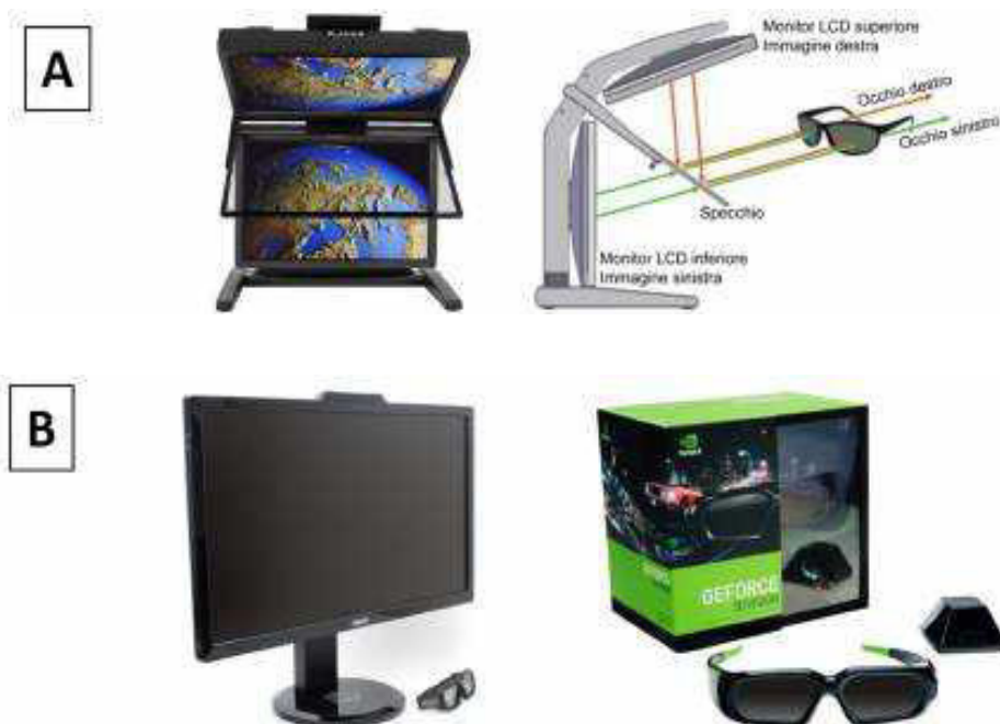
Figura 2-2. Caratteristiche delle due tipologie di sistema per la visione stereoscopica di immagini digitali. A) Stereoscopio digitale ad occhiali 3D passivi, con monitor Stereo-Mirror™ Planar. B) Stereoscopio digitale ad occhiali 3D attivi, con monitor 3D Vision-Ready e Kit Nvidia 3D Vision.
