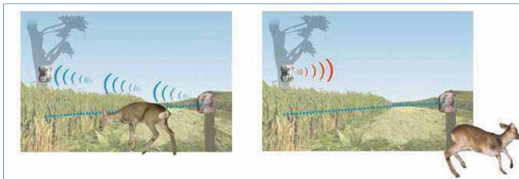
Figura 7.B – esempio di catarifrangenti per abbassare la probabilità di attraversamento della fauna selvatica
