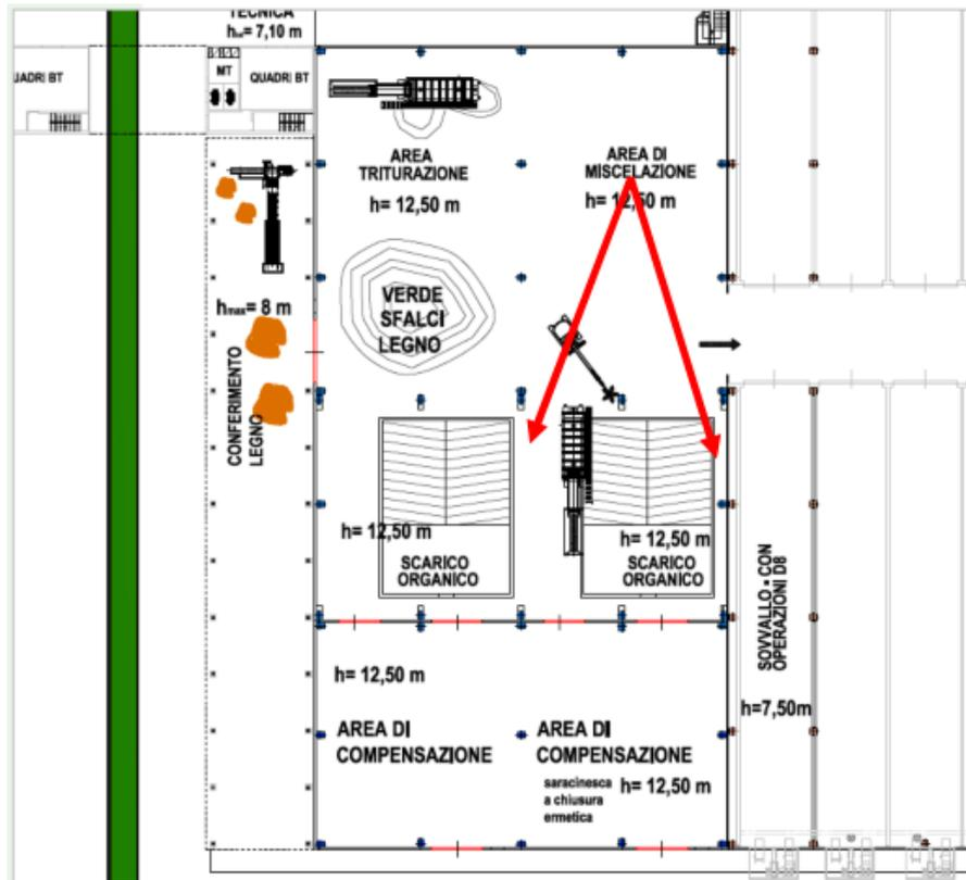
Figura 4: stralcio planimetrico T4.1 approvato. In evidenza le rampe per l'accesso alle fosse
