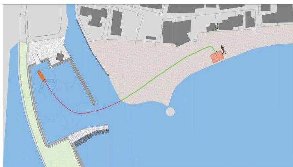
Figura 16: Planimetria di intervento, aspirazione mediante Draga refluenta, tubazione di mandata e sito di accumulo in prossimità del litorale;
