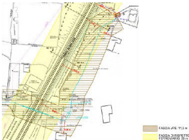
Fig 10 Soluzione B) – individuazione della fascia di rispetto ferroviario (giallo) e del Vincolo preordinato all'esproprio (retino marrone)
