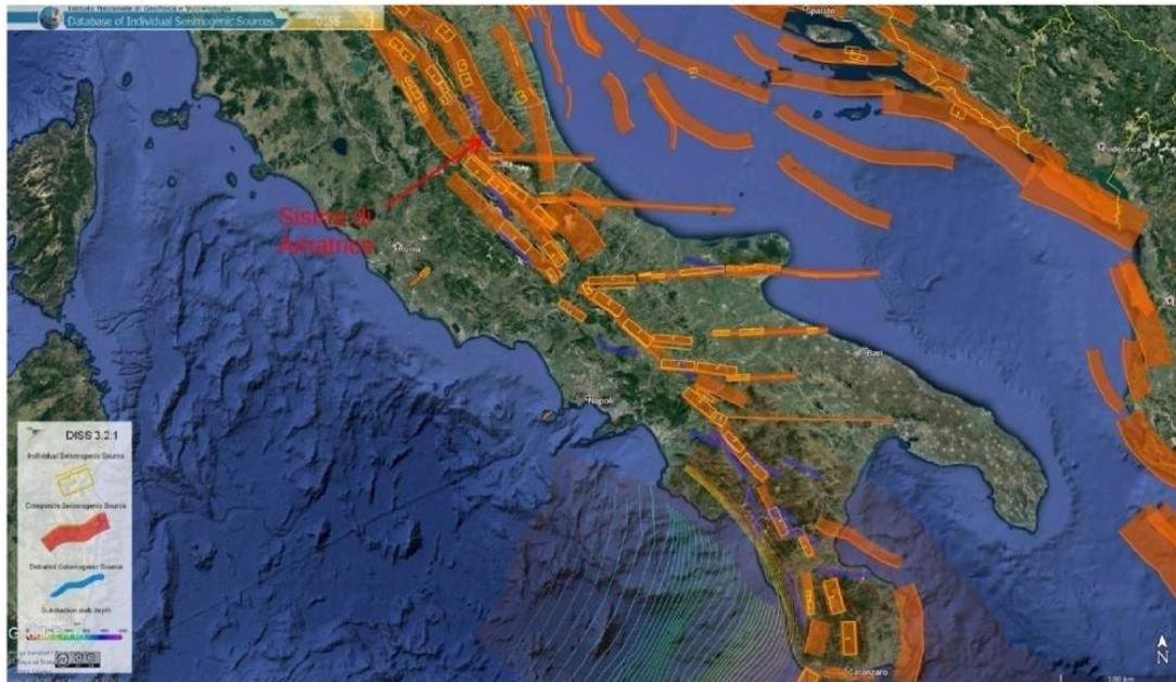
**Figura 17: Faglie sismogeniche come riportate nell'ultima versione del DISS. Si nota l'assenza di allineamenti multipli nell'area compresa fra il confine abruzzese-molisano e quello calabro-lucano, indice di una possibile mancanza di dati**
