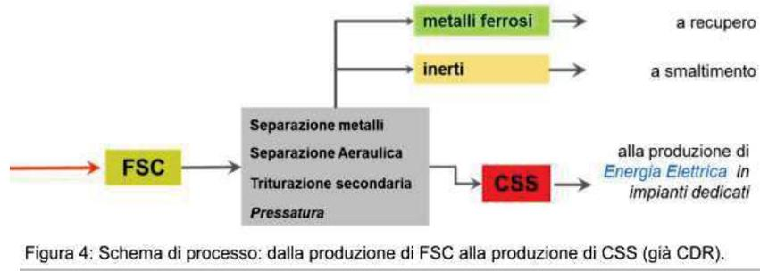
Figura 4: Schema di processo: dalla produzione di FSC alla produzione di CSS (già CDR).
