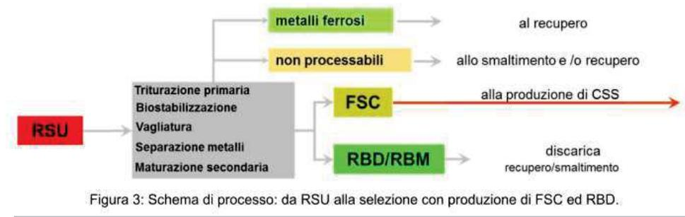
La FSC viene poi ulteriormente sottoposta a processi di lavorazione (separazione aerea, triturazione fine, ulteriore separazione dei metalli) per ottenere la produzione di CSS (in conformità del DM Amb. n. 22/2013) che a sua volta viene destinato alla produzione di energia elettrica in impianti idonei, mentre la
