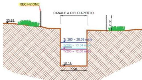
4. Realizzazione di **due attraversamenti stradali**: uno relativo alla viabilità di servizio del centro commerciale e l'altro di una strada comunale di larghezza 3.50 m realizzati con sezione scatolare in CA in opera.
