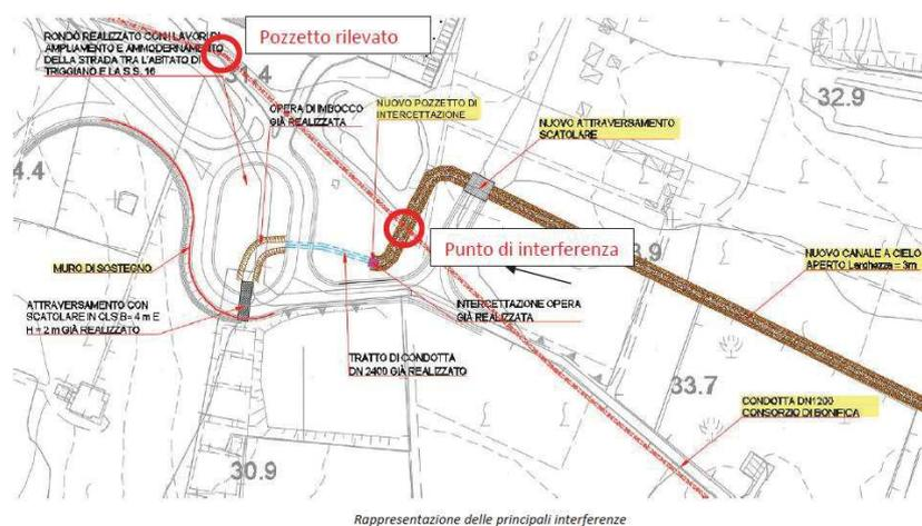
Dal pozzetto di scarico rilevato a monte del punto di interferenza si evince che la tubazione è in acciaio DN 1200 mm la cui quota di scorrimento è posta ad una profondità relativa di circa -2.70 m.
