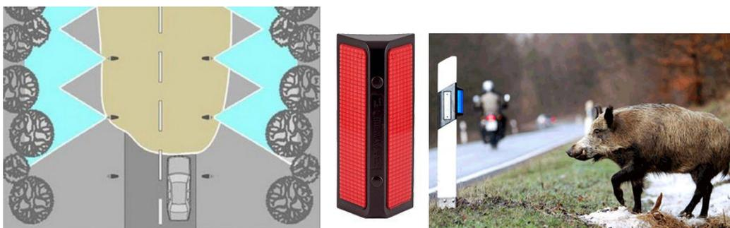
Figura 7.1.1.A – Esempio di catarifrangenti per abbassare la probabilità di attraversamento della fauna selvatica
