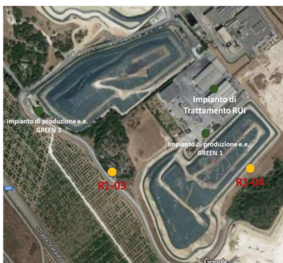
Figura n.13: Indicazione delle posizioni di monitoraggio del Rumore ambientale esterno scelte per la valutazione dell'impatto acustico prodotto dall'attività IPPC 5.3.
