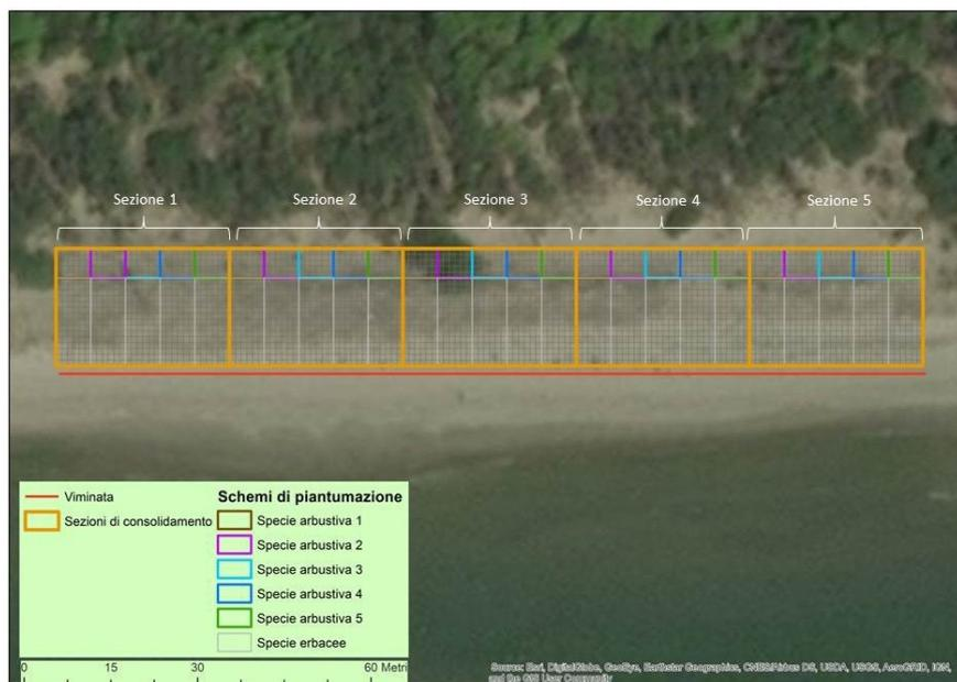
Fig.2 Rappresentazione tipo dello schema di intervento utilizzato per la ricostituzione dunale.
