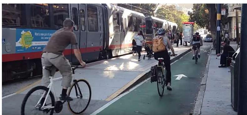
Figura 57 - Arretramento della corsia ciclabili in corrispondenza di una fermata BUS - San Francisco
