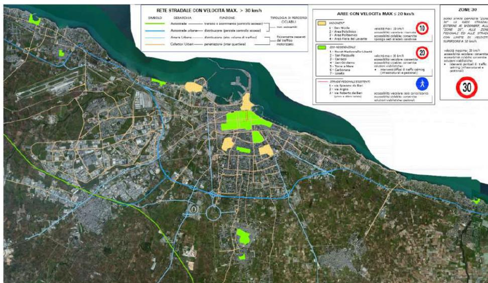
Figura 9 - Esempio di gerarchizzazione della rete stradale - città di Bari
