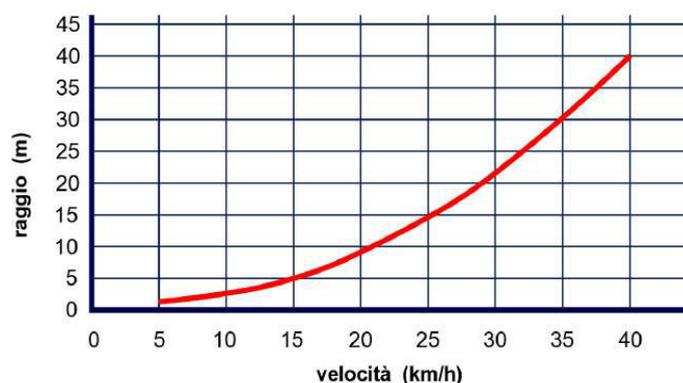
Figura 28 - Relazione fra velocità ciclabile e raggi di curvatura
