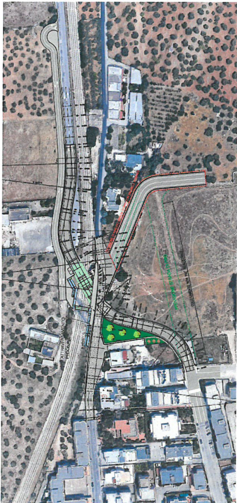
Immagine 3: Realizzazione nuova viabilità e sottopasso per eliminazione P.L. 16+524.
