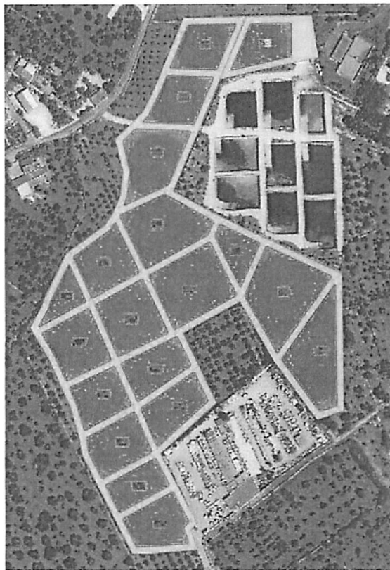
Fig. 9 – Schema posizionamento delle 19 nuove trincee drenanti
