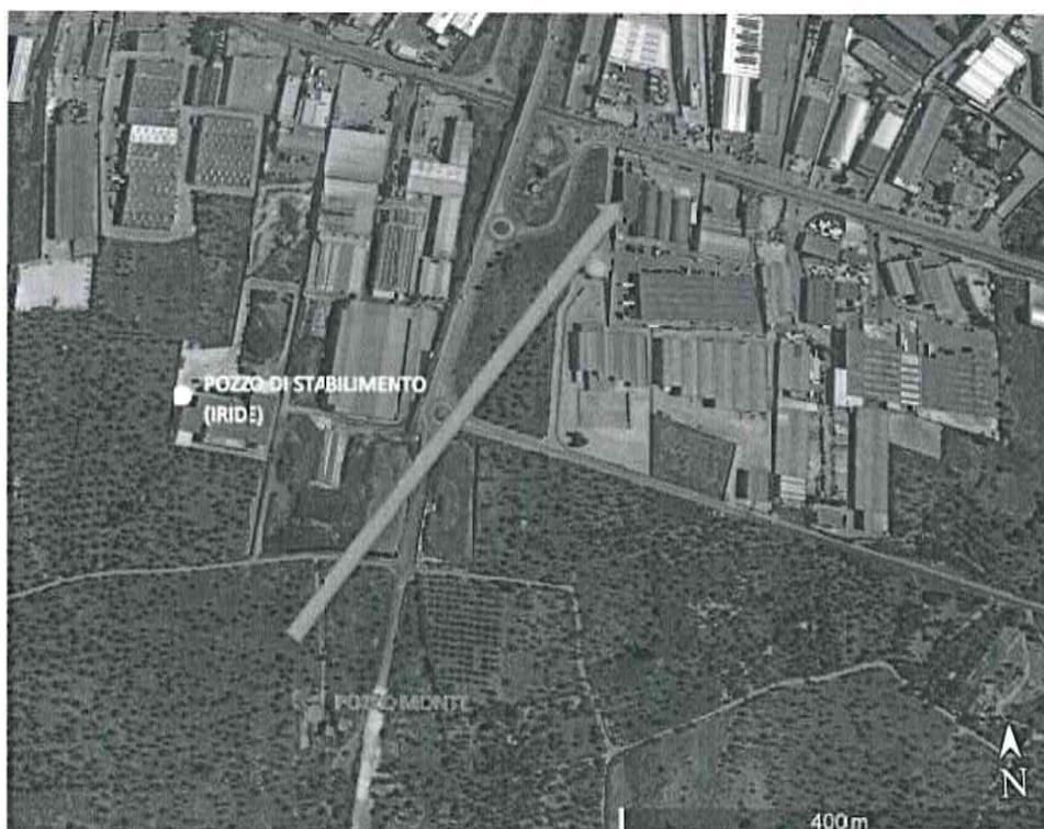
*Figura 3 – pozzi di monitoraggio falda*
