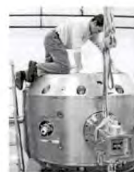
Magnete SC di Mevion (15 Ton, Synchrocyclotron)
