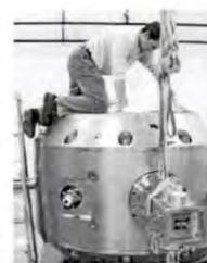
Magnete SC di Mevion (15 Ton, Synchrocyclotron)
