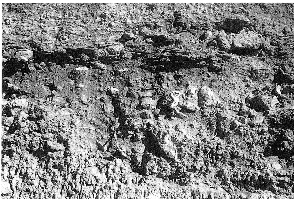
**Figura 8** Calcareniti alterate appartenenti alla Formazione delle Calcareniti del Salento, affioranti nella zona delle cave di Madonna delle Grazie, a sud dell'impianto di depurazione (mod. da T06)
