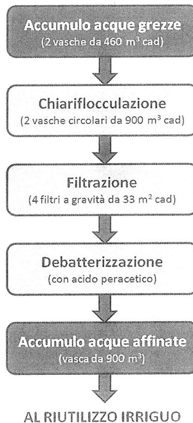
**Figura 14** Schema a blocchi della sezione di affinamento
